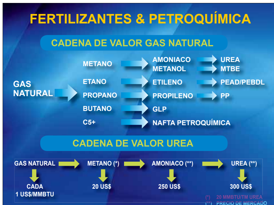
Ilustración N° 1 Valorización del gas natural industrializado
