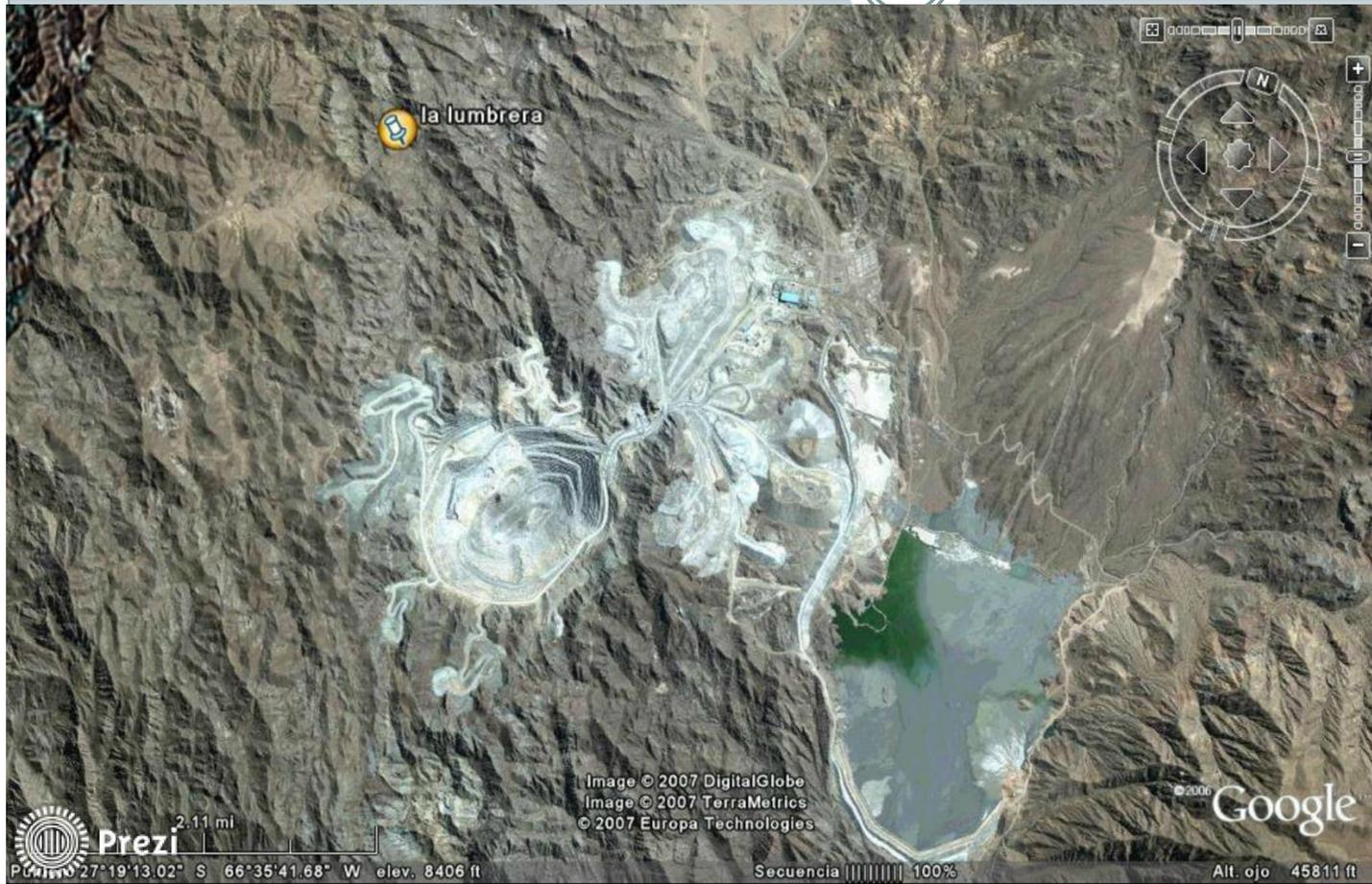
El dique de colas o de relaves de la mina Alumbraera fue emplazado en una zona de accidente geológico lo que provocó filtraciones de los desechos del proceso de extracción.
