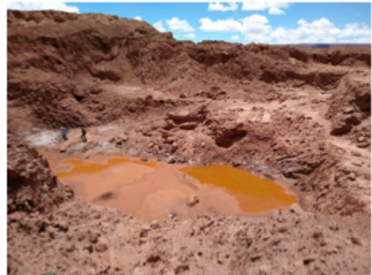
Foto 6.- Mina Cobrizos, excavación abandonada. Aguas muy salobres y alcalinas: EC=12,1 mS/cm , pH=9,45
