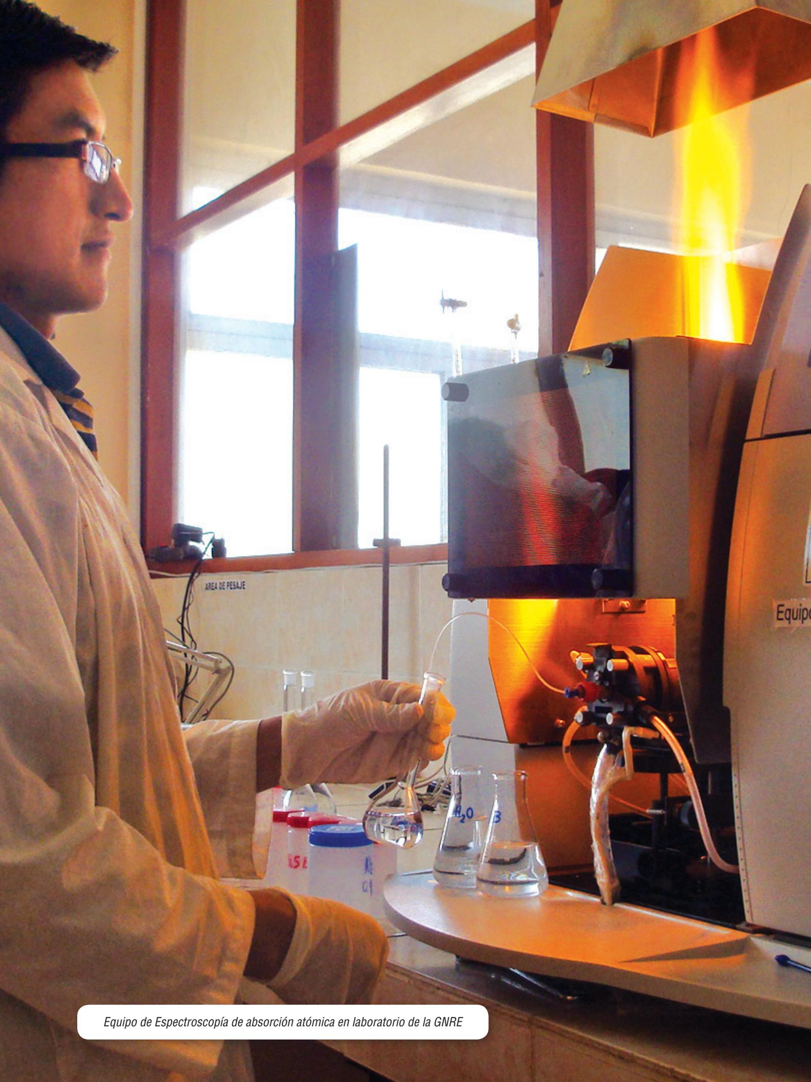
*Equipo de Espectroscopía de absorción atómica en laboratorio de la GNRE*
