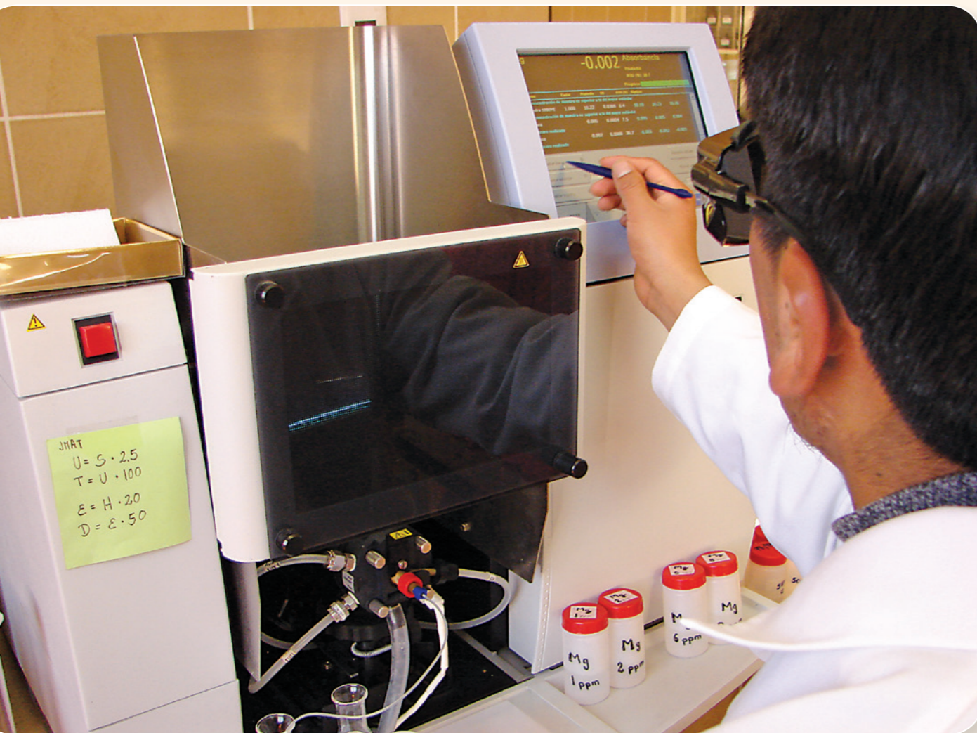
Análisis de laboratorio con el espectrofómeto de absorción atómica
