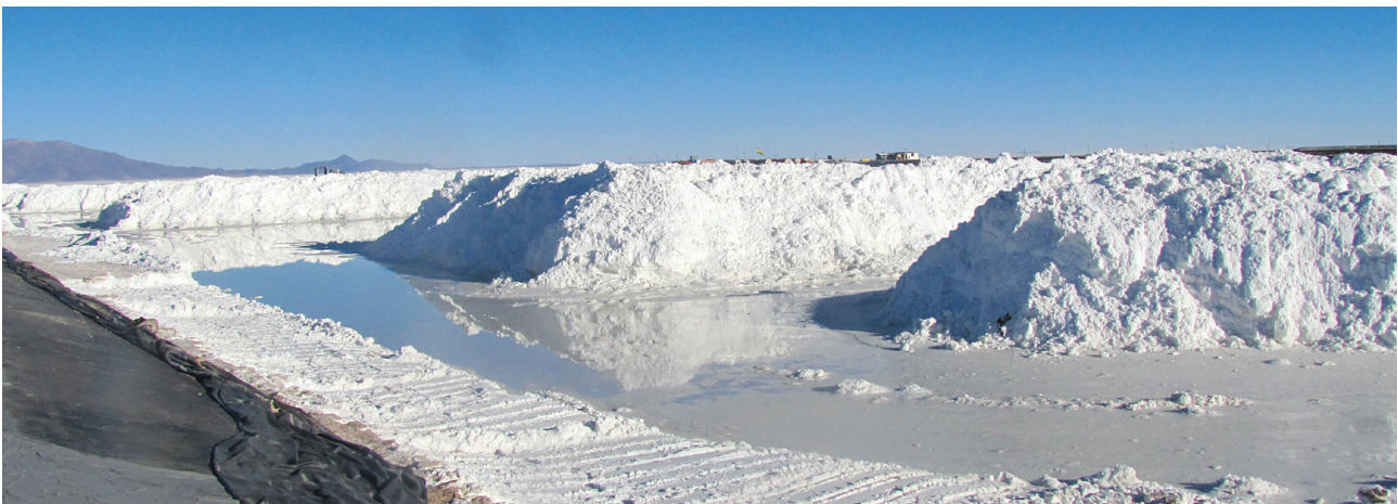
Acamellonado de Silvinita según grado de concentración.
