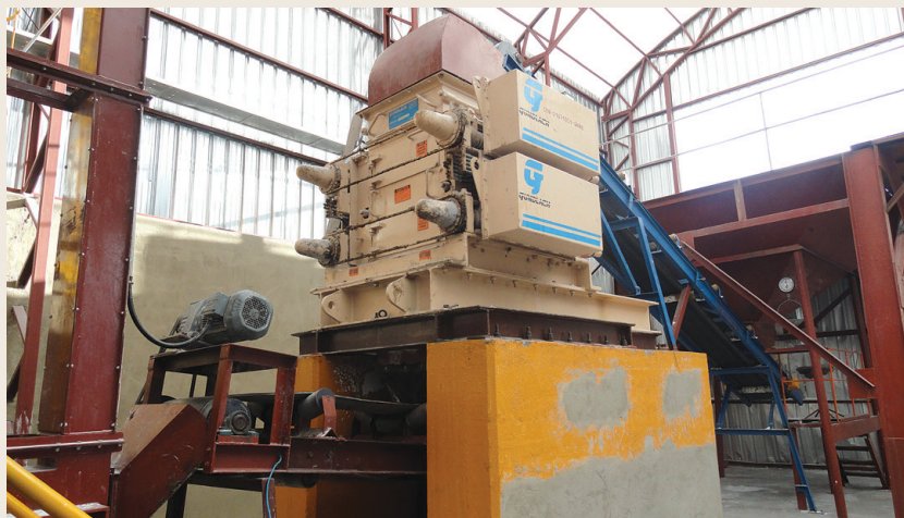
Molino de rodillos para reducir el tamaño de partículas de Silvinita
