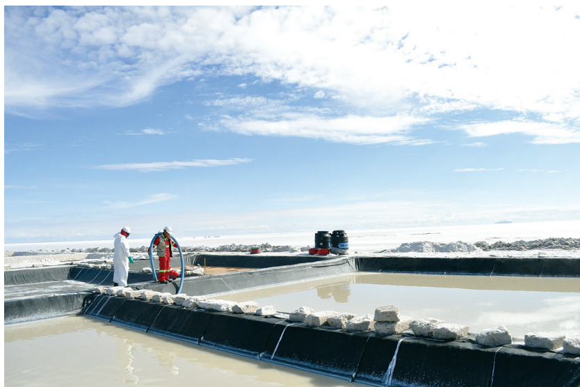
Piscinas de validación de primeras pruebas de laboratorio en el Salar de Coipasa
