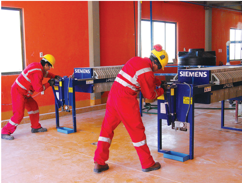
Técnicos de la GNRE operando los filtros prensa de Planta Piloto de Carbonato de Litio
