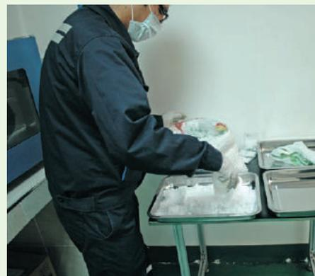
En la primera imagen, Hidróxido de Litio proceso en Planta Piloto de Llipi, en segunda imagen, condicionado de este material ( $\text{LiOH}\cdot\text{H}_2\text{O}$ ) para su respectivo secado en laboratorio de Planta Piloto de baterías y CICYT-MAT REB
