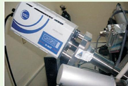
Espectrómetro de energía dispersiva
