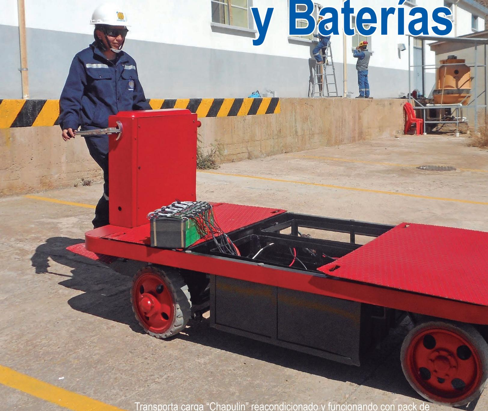
Transporta carga "Chapulin" reacondicionado y funcionando con pack de baterías de ion Litio ensamblado en Planta Piloto de Baterías de La Palca
