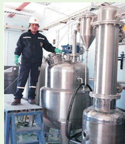
Técnico de la GNRE operando equipo cristalizador al vacío
