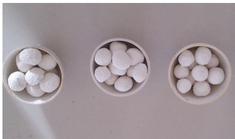
Pellets de lodos residuales de la Planta Piloto de Litio con la adición de material inerte
