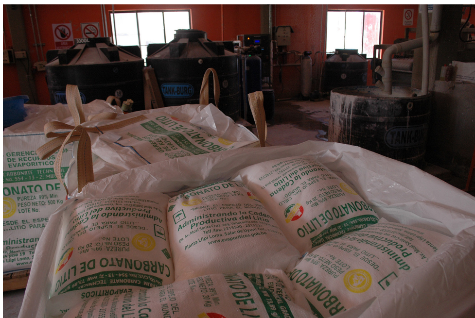
Empacado de Carbonato de Litio en Planta Piloto
