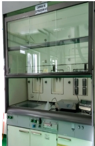
Campana de extracción
