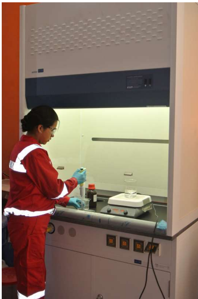
Personal de investigación efectuando pruebas de carbonatación
