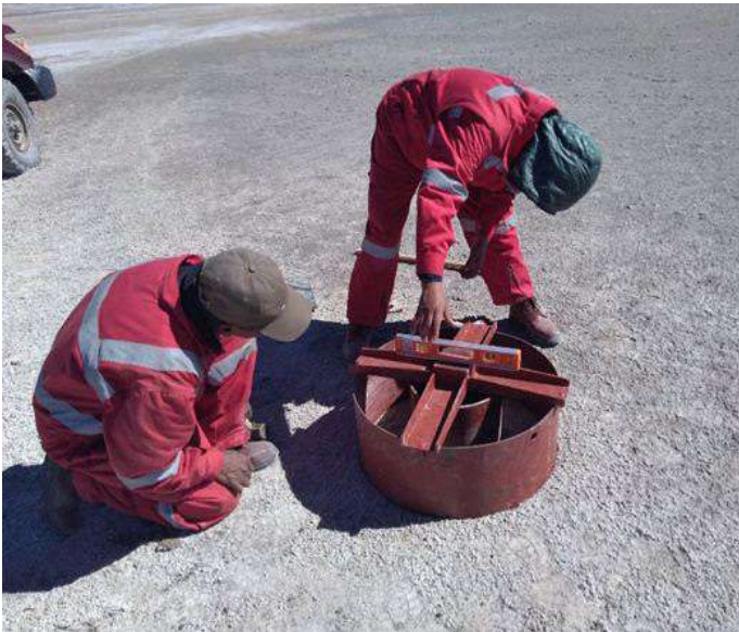
Prueba de conductividad hidráulica con anillas concéntricas
