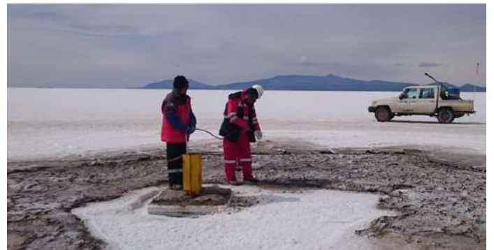
Toma de muestra durante el monitoreo de pozos en el Salar de Coipasa
