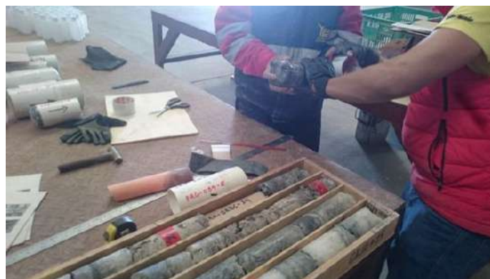
Muestreo y embalado de testigos de perforación para análisis de RBRC
