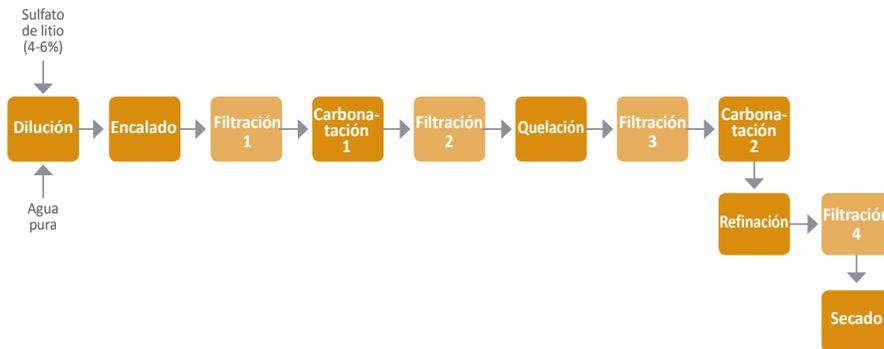
**Figura 16** K-UTEC: diagrama de flujo del diseño mejorado para la planta industrial de carbonato de litio.
