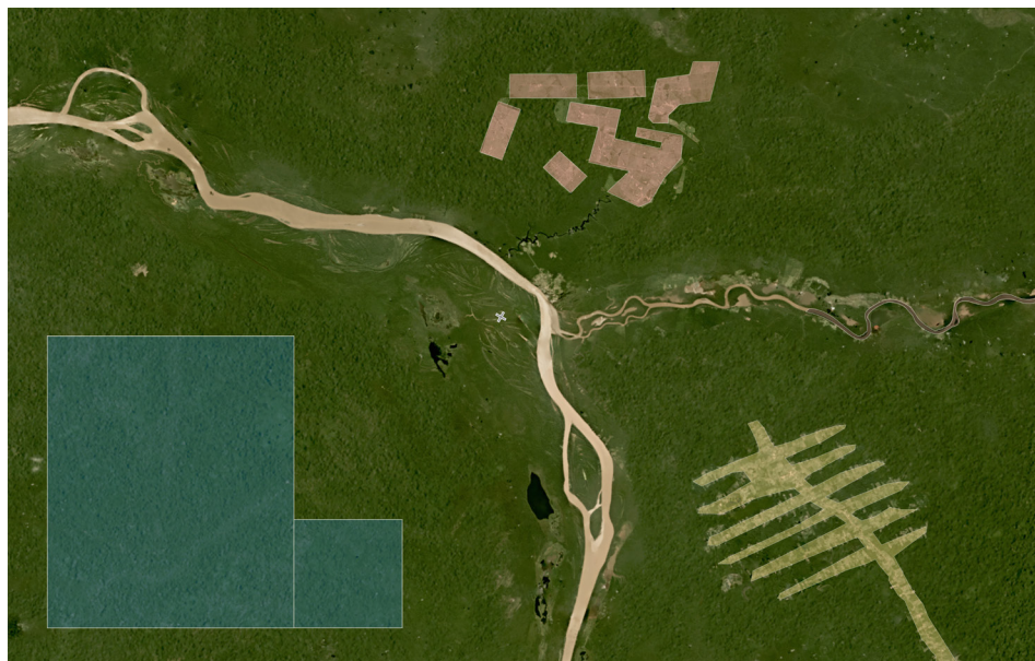
Figura 2.4 Principales tipos de fragmentación extrovertida en la Amazonía: bloques de concesiones petroleras, concesiones mineras, deforestación radial o en peine por acciones agropecuarias y, a lo largo de un río, por la minería de oro aluvial.
