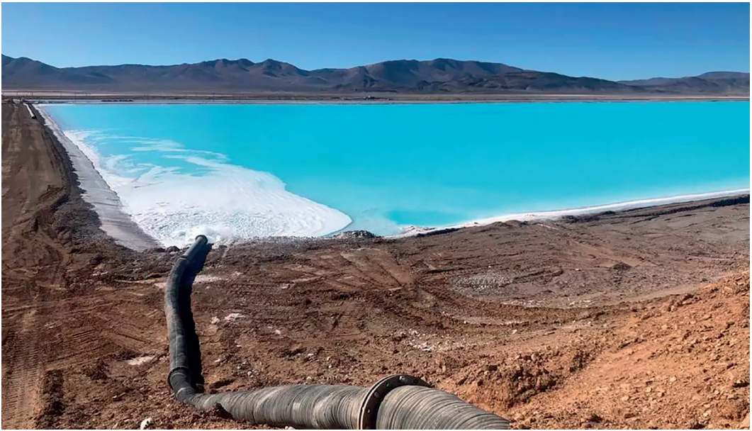
Salar de Olaroz, provincia de Jujuy, Argentina. Piletón de salmuera para la evaporación del agua y así aumentar la concentración de litio.
